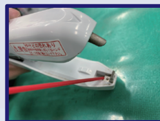
溶着金具の隙間
