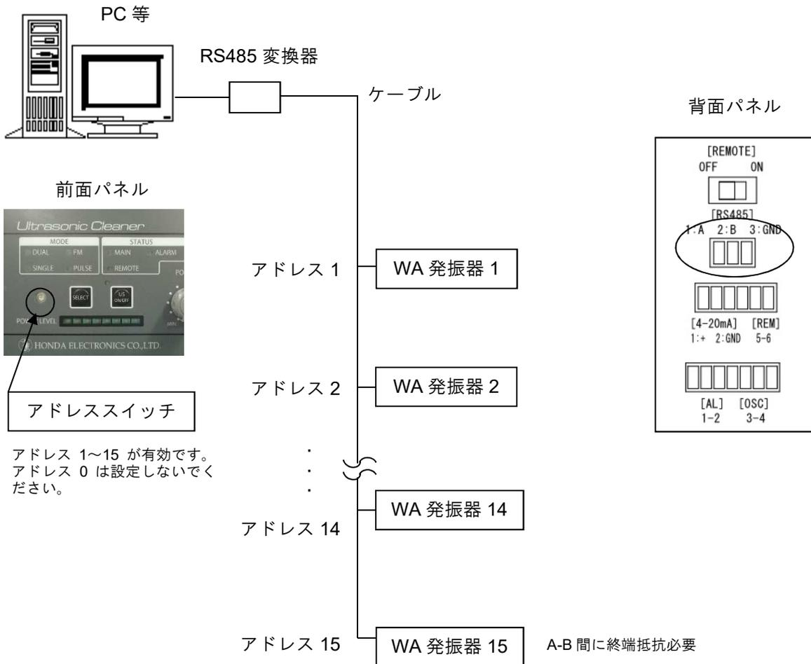
1. I/O 端子の[RS485]端子（3P コネクタ、1-3 番）に、RS485 通信用信号線を接続します。
