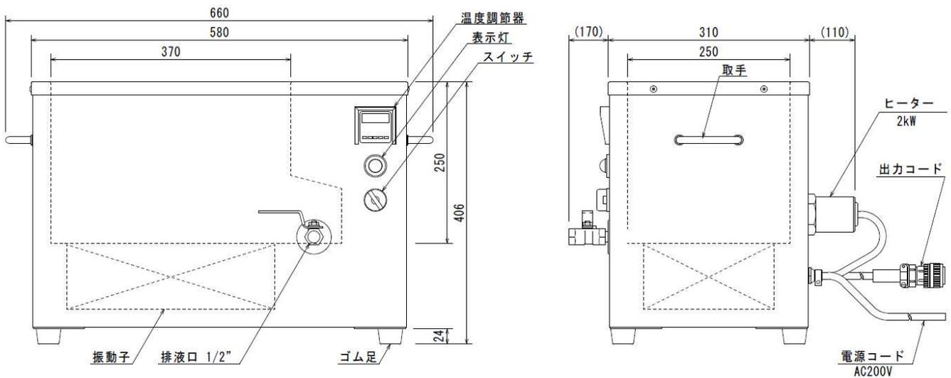
●ヒーター付洗浄槽タイプ：外形寸法（WA-1200）（単位：mm）
