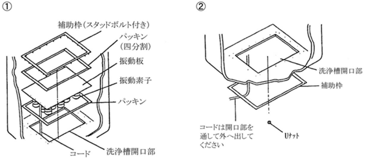
4. 振動子コードを洗浄槽の外に引き出し、出力コードと接続します。
