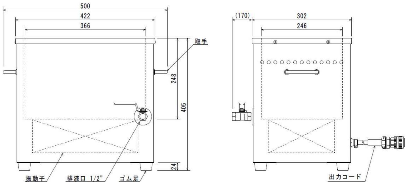
● 洗浄槽タイプ：外形寸法 (WA-1200) (単位：mm)
