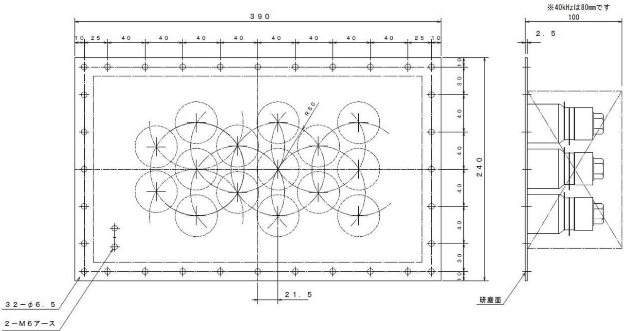
●振動板タイプ：外形寸法 (WA-1200) (単位：mm)
