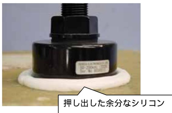
シリコンが固まるまで接着部分がずれないように注意して下さい。(シリコン接着剤の硬化には約24時間かかります。)
