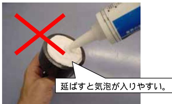
振動子を接着部の真上から強く押さえつけ、気泡と余分なシリコンを押し出す。(シリコンの厚みが薄いほど感度が減少しにくい。)
