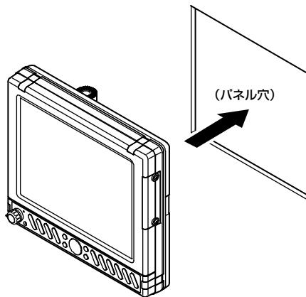
5. 4×30 タッピングネジを挿入してパネルに固定します。（4箇所）
