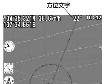
**1** メニューから「6. 表示設定」→「3. 自船表示設定」→「9. コンパス表示設定」→「3. 方位文字表示」を選択します。
