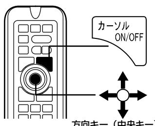
1 [カーソル ON/OFF] キーを押して、カーソルを表示します。
