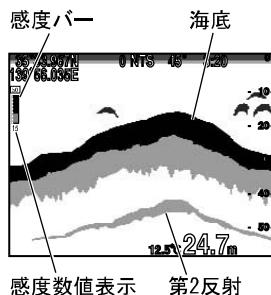
海底や魚群を判別しやすくするために、受信機の感度を調節します。(0~40 : 41 段階のバー表示) また、感度バーの下に設定値を 0 から 40 の数値で表示します。判別するのに最適な感度は、海底の第2反射がうつり、海底が赤く表示されるくらいの設定です。
