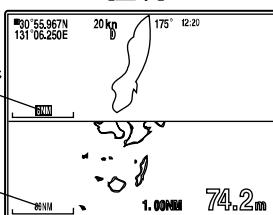
地図2画面表示の場合、[□]キーで拡大、縮小の操作を行える画面を切り替えることができます。但し、[□]キーがユーザーキー、マイメニューあるいは画像保存に設定されている場合は、[□]キーの長押しで、拡大、縮小の操作を行える画面を切り替えます。操作できる画面のレンジが四角の枠で表示されます。
