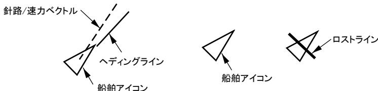
※同時に表示できる船舶アイコンは 50 個までです。50 個を超えると自船から最も遠いアイコンが消去されます。
