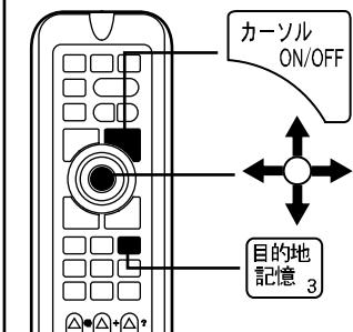
1 [カーソル ON/OFF] キーを押し、カーソルを表示させます。
