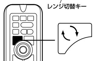
[□]キーをレンジ切替として設定しておくと、よく使うレンジをワンタッチで切り替えることが出来ます。レンジは2つまで設定でき、[□]キーを押して切り替えます。
