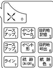
目的地航法を設定すると、自船位置から目的地までを線で結び（コースライン）、画面左上には目的地の緯度・経度、自船位置から目的地までの距離、方位、到着予定時間または所要時間が表示されます。
