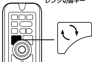
〔i〕キーをレンジ切替として設定しておく、よく使うレンジをワンタッチで切り替えることができます。レンジは2つまで設定でき、〔i〕キーを押して切り替えます。
